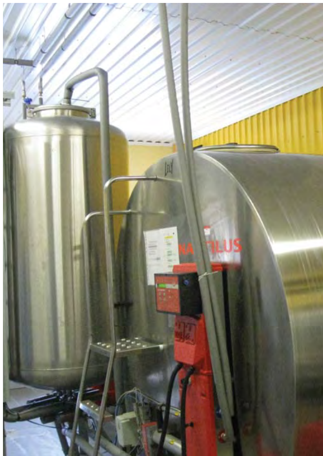
Joonis 32. Seiretalu piimatank (vasakul) ja plaatsoojusvaheti lüpstava piima soojuse taaskasutuseks (paremal)
