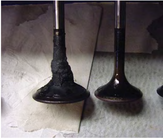
Joonis13. Rapsi- ja sinepiõlist põhjustatud moodustised Valmet 420 mootori väljalaskeklapi kaelal (vasakul) ja klapipesas (paremal)
