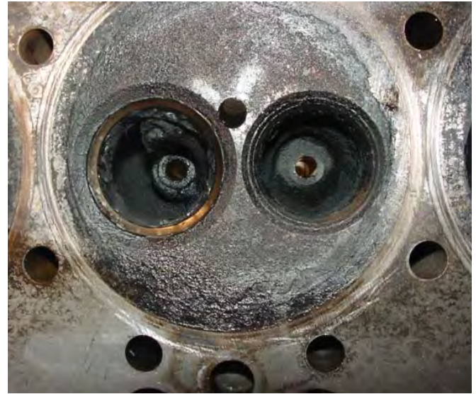
Joonis13. Rapsi- ja sinepiõlist põhjustatud moodustised Valmet 420 mootori väljalaskeklapi kaelal (vasakul) ja klapipesas (paremal)
