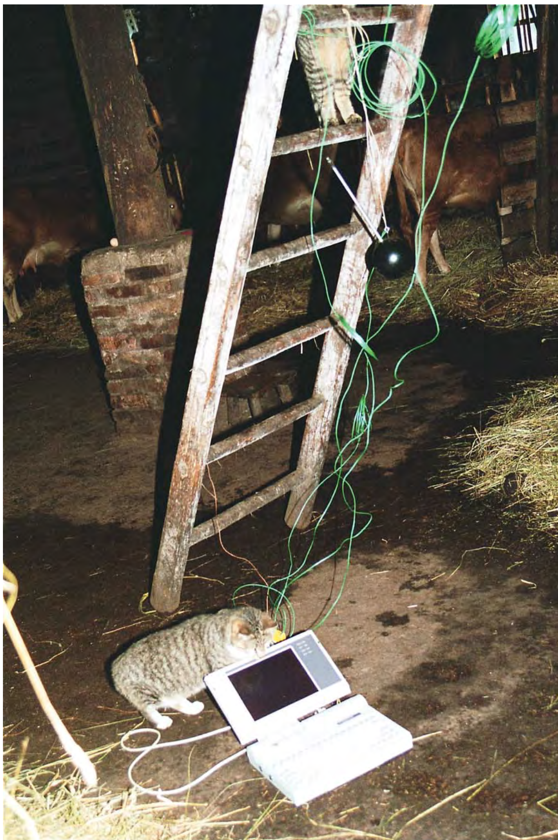
Kantava mõõtesüsteemi rakendamine C. R. Jakobsoni talumuuseumi laudaõhu temperatuuriseireks (foto: Väino Poikalainen)
